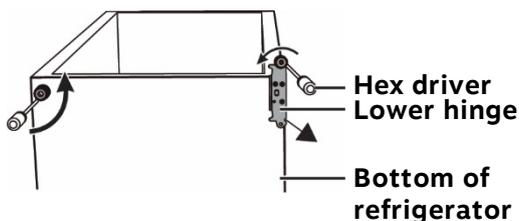
9. Reassemble the bottom hinge:
